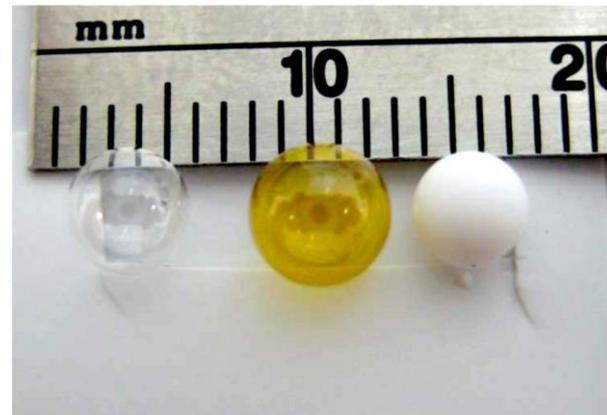
Гранулы: слева, 4 мм Poly alpha methyl styrene (PAMS) гранула с толщиной стенок 35 микрон; в центре, Glow Discharge Polymer (GDP) гранула – 20 микрон; справа, 4 мм Divinil Benzene (DVB) гранула – 260 микрон.
